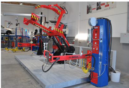
TL-2 auf Plattform mit SEDA DrainTower
