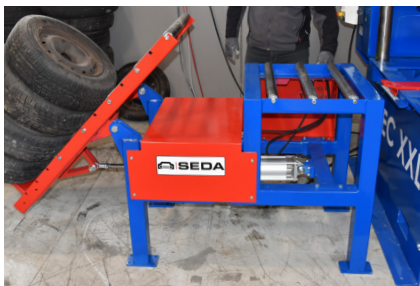
Einfaches Zuführen der zu trennenden Räder durch den optionalen FEEDER
