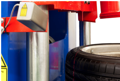
Laserunterstützung bei der Reifen-Ausrichtung
