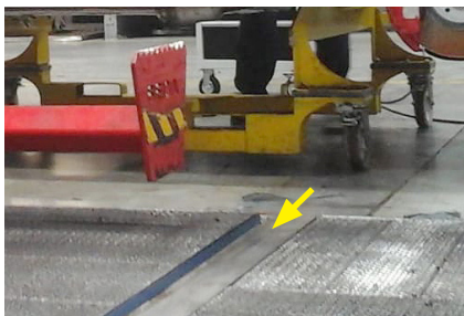
Perfekte Führung des Trolleys durch spezielle Führungsrillen in den Auf-fangwannen
