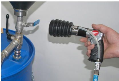
Absaugen mittels Bohrgerät in den Gerätetank
