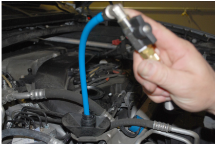
Absaugen mittels Sauglanze in den Gerätetank
