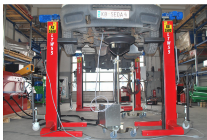
SEDA Truckstation ED als alternatives System mit Hebebühne
