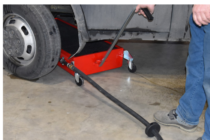
Mobile Auffangwannen für Altöl und Kühlflüssigkeit
