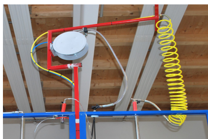
Schwenkgalgen mit Werkzeugen zur Flüssigkeitsabsaugung
