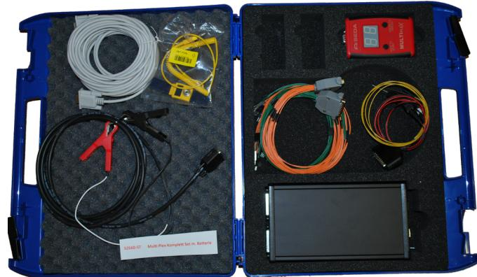
Vor dem Anschließen muss sichergestellt werden, dass das Fahrzeug spannungsfrei ist: Sämtliche Batterien und Hilfsbatterien müssen abgeklemmt und die Polklemmen kurzgeschlossen sein. Bei der Cableversion erfolgt die Stromversorgung über eine separate Autobatterie.
