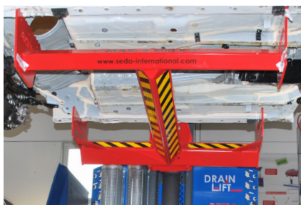
Frei zugänglicher Unterboden durch H-Gabel
