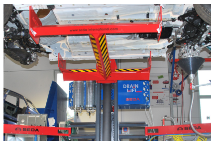
Frei zugänglicher Unterboden durch H-Bühne
