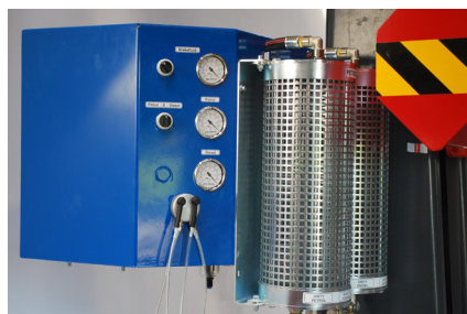
Pumpengehäuse mit Sichtbehälter für Benzin und Diesel
