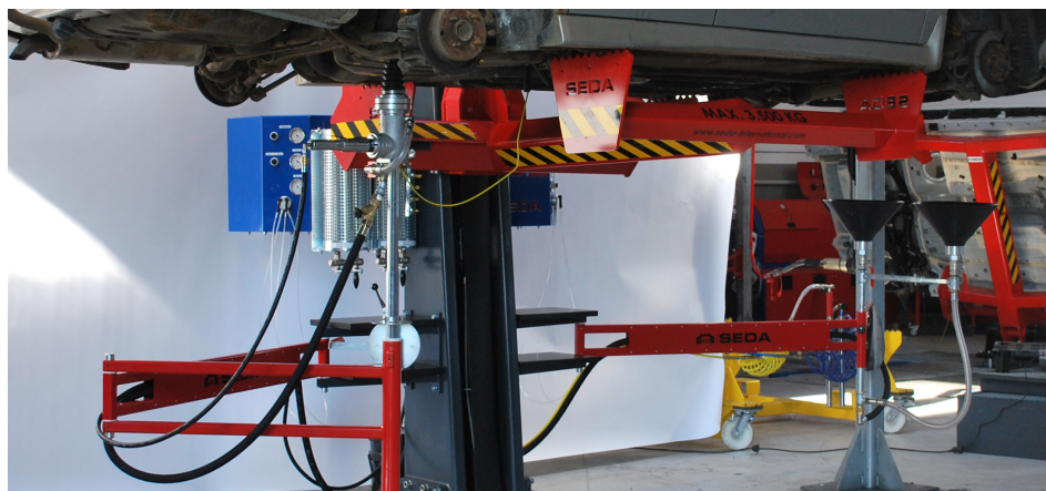
Trockenlegung mit Tankanbohrgerät auf Schwenkarm
