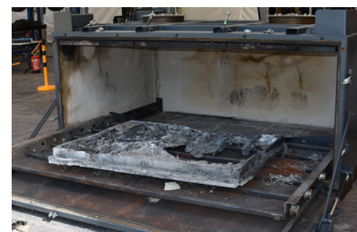
HV Bat-Box mit ausgebrannter Auto-Batterie
