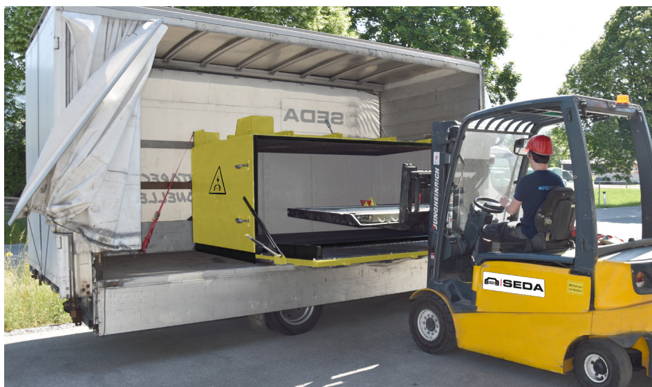
Beladung der HV Bat-Box mit Auto-Batterie direkt am Lkw
