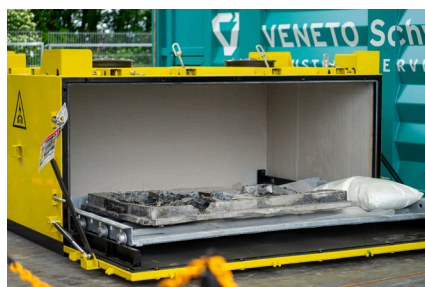
Die ausfahrbare Rollbahn ermöglicht eine einfache und effiziente Beladung.
