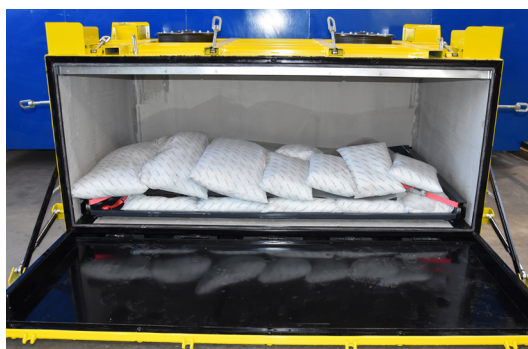
HV Bat-Box beim Beladen mit HV-Speicher und Glasfaser-Kissen zum Ausfüllen
