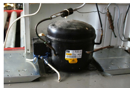
Kompressor im Klemmbereich fixiert
