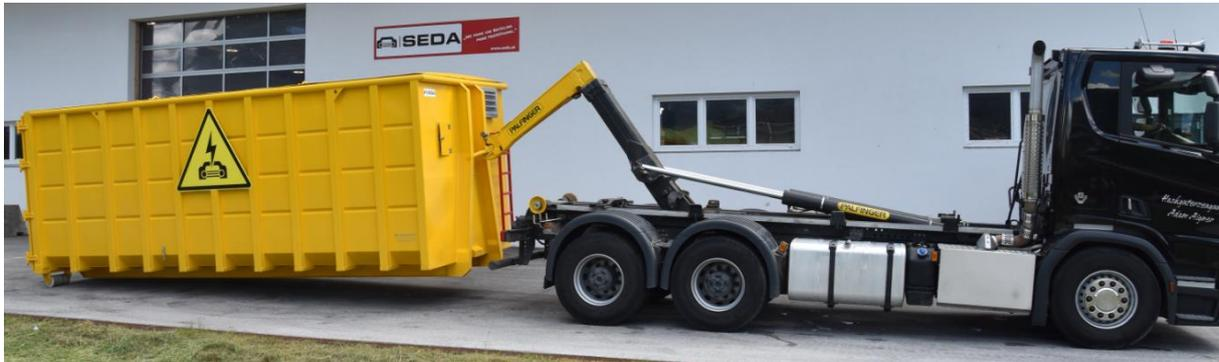
Der **Q-tainer** für Fahrzeuge ist für den **sicheren Abtransport** und als **lokaler Quarantäneplatz** gedacht. Messwerte haben ergeben, dass die stationäre Verwendung ohne Filterung auf dem Betriebsgelände die europäischen Emissions- und Immissions-Richtlinien nicht erfüllen. Hier ist eine Filtertechnik zwingend notwendig, um eine Betriebsanlagengenehmigung zu erhalten.
