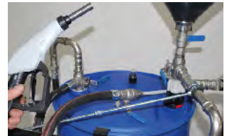
Ontleding middels een pomppijp in een lagertank
