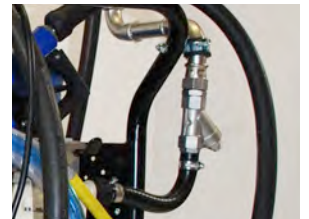
Roestvrij staal leidings Filter: Zeef moet wekelijks worden gereinigd
