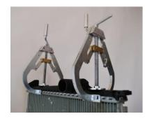
"Das SEDA Kühlerspannzwingen Set ist universell einsetzbar und einfach zu bedienen. Bei richtigem Einsatz wird die Gefahr einer falschen Montage des Wasserkastens und mögliche Konsequenzen (Undichtheit) auf ein Minimum reduziert."
